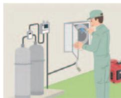
専用のガスコード収納ボックスを設置して、ご家庭で使用されているプロパンガスをそのまま燃料としてお使いいただけます。発電機のための燃料や専用LPガス容器を備えておく必要がなく、ガソリンタイプの発電機と違い燃料のメンテナンスも不要です。
