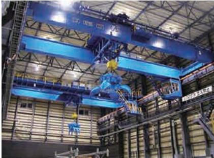
スクラップヤードディーラーへ納入 7.5/7.5ton×20mリフマグ・クラブ付天井クレーン
