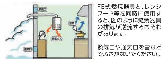
FE式燃焼器具と、レンジフード等を同時に使用すると、図のように燃焼器具の排気が逆流するおそれがあります。
